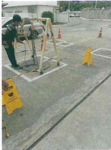
รูปที่ 80 โครงการมีการตรวจสอบคุณภาพน้ำก่อนเข้าสู่ระบบบำบัดน้ำเสีย และหลังผ่านการบำบัด เดือนละ 1 ครั้ง
